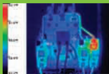
このエバポレーター・ポンプは、C相の接続部分の温度が50°高くなっていることが分かります。
